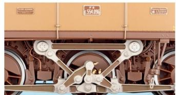
Die Bilder zeigen die eindrückliche, asymmetrische Bauform mit dem hohen eckigen Vorbau, in dem der elektrische Teil untergebracht ist. Der gerundete niedrigere Vorbau enthält den Anfahrwiderstand, der durch Eintauchen von Polplatten in eine Salzwasserlösung das sanfte Anfahren ermöglicht. Die Ölgefäße auf dem Gelenkkopf des Antriebs sind gedreht und wurden anschliessend vergoldet. Ein besonderes Schauspiel liefern die Antriebe des Kompressors und jener der Friedmann-Schmierpumpe.
