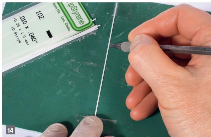
**Bilder 14 und 15:** Ich fahre mit dem Bau des an den Kanten zu befestigenden Holzrahmens fort. Für dieses grossflächige Beispiel verwende ich Evergreen-Leisten (Art.-Nr. 102), die ich auf der Schneidematte mit einem Stück Klebeband befestigte. Ein wenig Ritzarbeit mit einer Reissnadel ergibt die Illusion von Holzmaserung. Die Abschnitte werden mit einem Film aus Cyanacrylat an Ort und Stelle gehalten.
