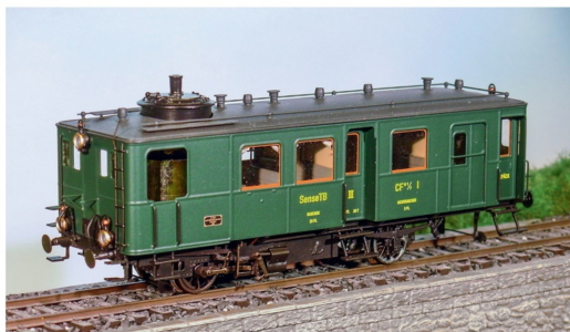
Vom richtigen Vorbild abgeleitet ist der CFm 1/2 1 vom Modellbahnstudio Born. Die andere Kastenform und -aufteilung ist gut erkennbar.
