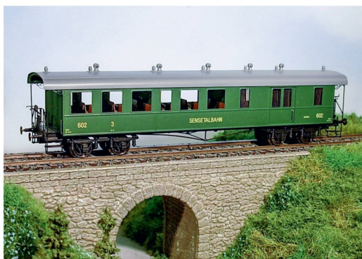
Alles in einem Wagen: Der CFZ4 602 war der grösste Wagen bei der STB. Mit 17,3 Metern Länge über Puffer ist er fast dreimal so lang wie die Loks.
