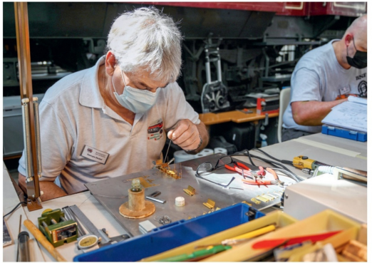
Für das Widerstandslöten braucht es eine ruhige Hand und etwas Geduld.
