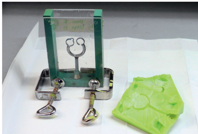
Das Urmodell in der Ausgangsform, in der die Silikon- oder Gummigussform hergestellt wird.
