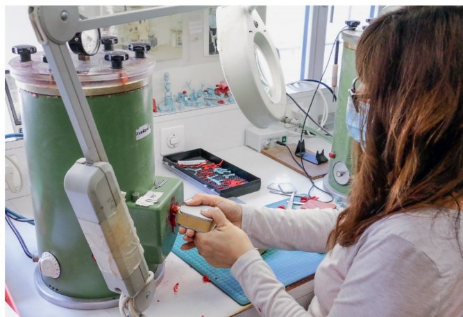
Eine Gussform mit dem Wachs. Dieser Schritt wird in der Regel mehrfach wiederholt.
