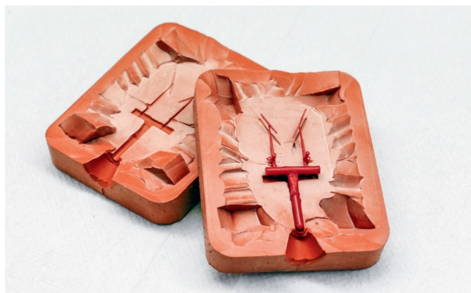
Eine Gussform mit dem Wachs. Dieser Schritt wird in der Regel mehrfach wiederholt.
