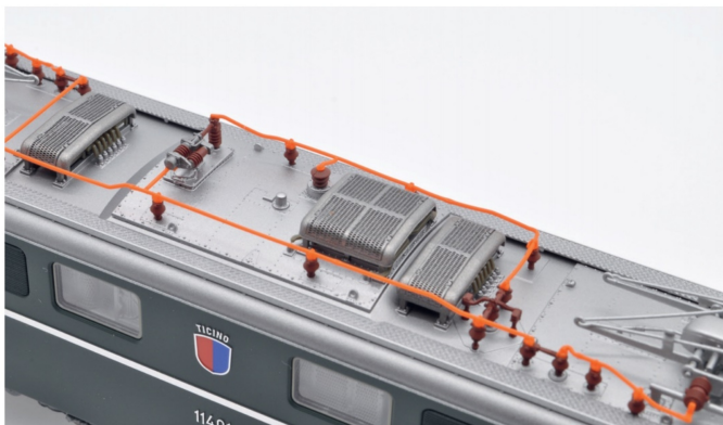
Die Widerstandshauben und der Hauptschalter sind sehr detailliert gestaltet.
