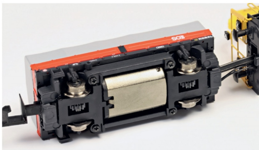
Der fünfpolige Motor in der Mitte treibt sehr direkt beide Achsen an.
