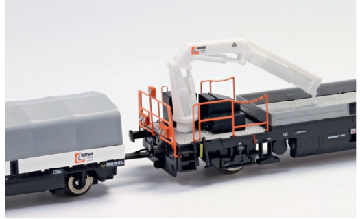
Der Robel und sein Anhänger sind mittels Kuppelstange fest verbunden.
