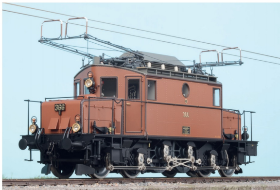
Ab 1920 galt bei den Simplonlokomotiven diese Farbgebung mit dunkelbraunen Absetzlinien und sehr filigranen, gelben Zierstreifen.
