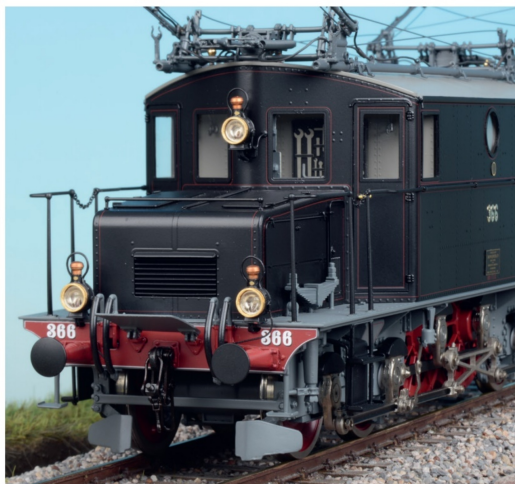
Die Pufferbohle ist im Charakter der Jura-Simplon-Bahn gestaltet. Die Laternen mit Messingring haben einen echten Kupferkamin.
