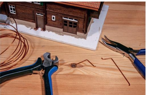
Die Fallrohre der Dachrinnen werden gemäss dem Vorbild aus dickem Kupferdraht gebogen und an die entsprechenden Stellen geklebt.
