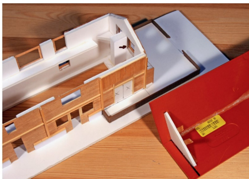
Das Dach besteht aus Kunststoffplatten, die mit Winkelementen zu einem Bauteil montiert werden. Holzleisten dienen als Führungselemente.
