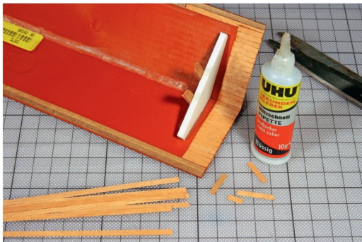
Mit Furnierholzstreifen bildet man die Schalung an den Unterseiten der Dachflächen nach. Im Bereich der Gebäudewände bleibt der Bereich frei.
