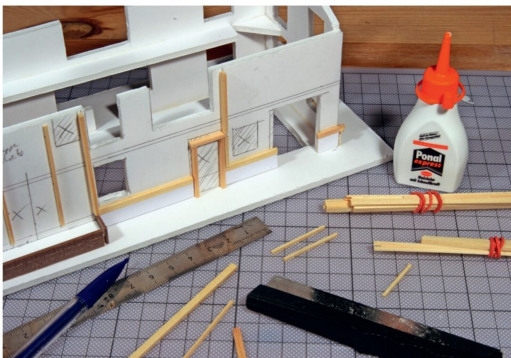
Aus Profilholzleisten werden die überstehenden Bretter der Holzwände nachgebildet. Sie werden mit Holzleim auf den Hartschaum geklebt.
