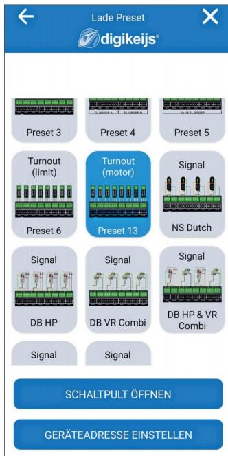
Die Konfiguration der Decoder erfolgt über sogenannte Presets. Hier wird eine Funktionalität ausgewählt und dem Decoder zugewiesen.
