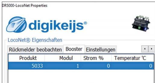
Beim Einsatz mehrerer Booster nützt die Anzeige von Überwachungsfunktionen: Der Booster DR5033 übermittelt ein paar Daten per LocoNet.
