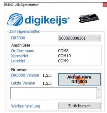
Auf Windows-Rechnern stellt die Konfigurationssoftware gleich drei Com-Ports bereit. So kann man mit der DR5000 wahlweise über XpressNet- oder LocoNet-Befehle kommunizieren. Gängige Steuerungsprogramme unterstützen meistens beide Systeme.
