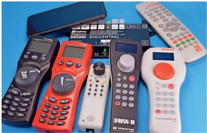
Eine Auswahl der Handregler, die sich mit der DR5000 verwenden lassen. LocoNet- und X-Bus-Handregler lassen sich direkt einstöpseln. Mit der wlanMaus und der Digi-Fern lässt sich sofort ein drahtloser Betrieb aufnehmen. Das Smartphone lässt sich per WLAN mit der Digitalzentrale verbinden. Zur Steuerung dient hier die Z21-App.
