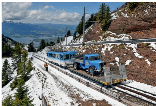
Der Tiefgangswagen X 105 verkehrte mit dem BDhe 4/4 15. Er war mit einem mit Kohle bestückten FBW der Firma Kennel aus Goldau beladen.
