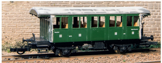
Der Zweiachser der SOB im Rohbau. Die Anschriften des Spenderwagens sind noch ersichtlich.
