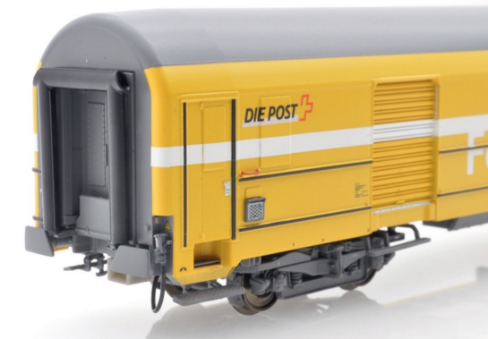
Das Wagenende mit dem Zettelkasten und der Zugsammelschiene.
