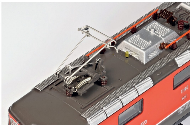
Der neue feine Einholpantograf der Hobbytrain Re 420 mit vernünftiger Ausfahrhöhe.
