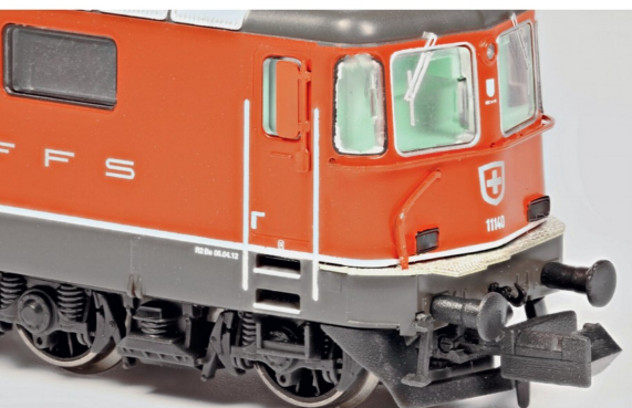
Die steckbare N-Kupplung: der einzige Hinweis auf das Modell in 1:160.
