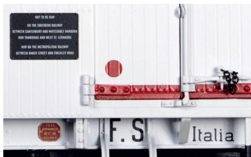
Das RCH-Schild links unten bestätigt die Zulassung in England. Jeder Wagen erhielt eine eigene Nummer, so auch im Modell (siehe das Bild rechts).
