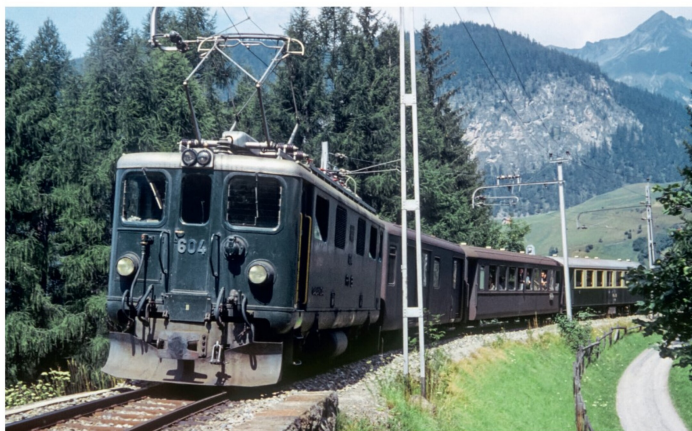
Die 604 im Auslieferungszustand mit Türen vorne am Führerstand und Fenstern im Maschinenraum.
