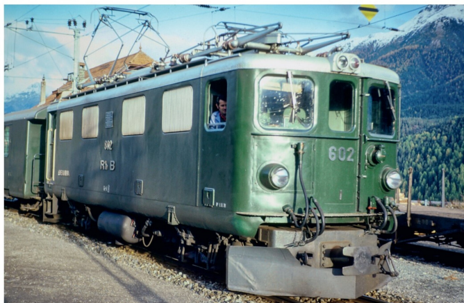
Die 602 behält bis zum Umbau der Führerstände die grosse Steckdose der Vielfachsteuerung.
