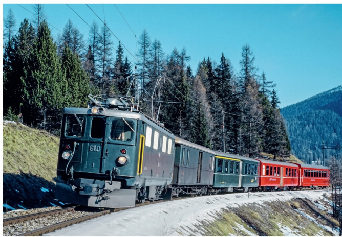
Blick auf den Führerstand I der Ge 4/4 1 610 mit der vertikal verlaufenden ausklappbaren Leiter.
