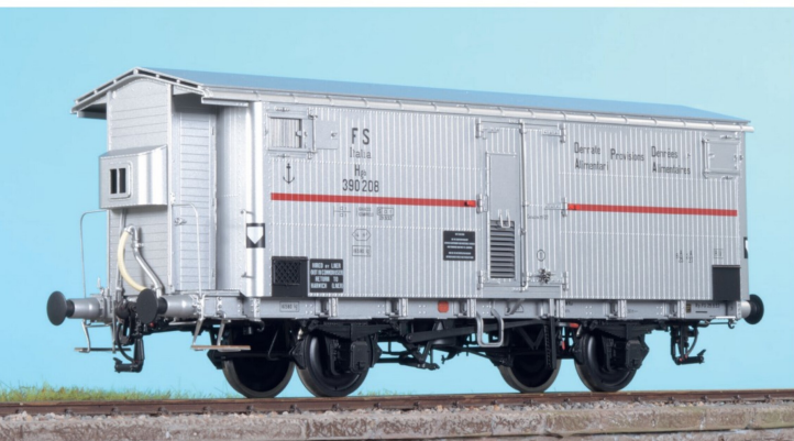
Diese Spezialversion war mit zusätzlichen Lüftungsjalousien in den linken Türen ausgerüstet.
