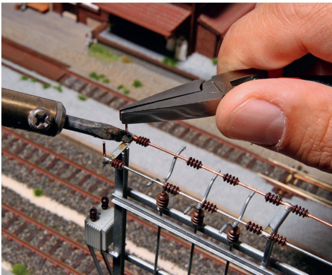
Der Schaltposten wird vor dem Aufstellen mit drei Schaltern für die Gleise und einem für den Masttrafo bestückt. Der Schaltposten wird direkt an einem Fahrleitungsmast angeordnet.
