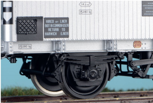
Die moderneren Versionen der Modellkühlwagen sind vorbildgerecht mit neuen RIV-Lagern und mit Doppelfederung ausgestattet.
