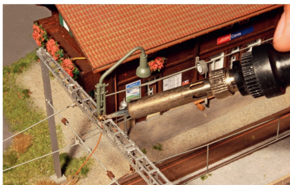
Eine Laterne wird auf das Querjoch gelötet. Die Anschlussdrähte führen durch das Joch und am seitlichen Mast nach unten.
