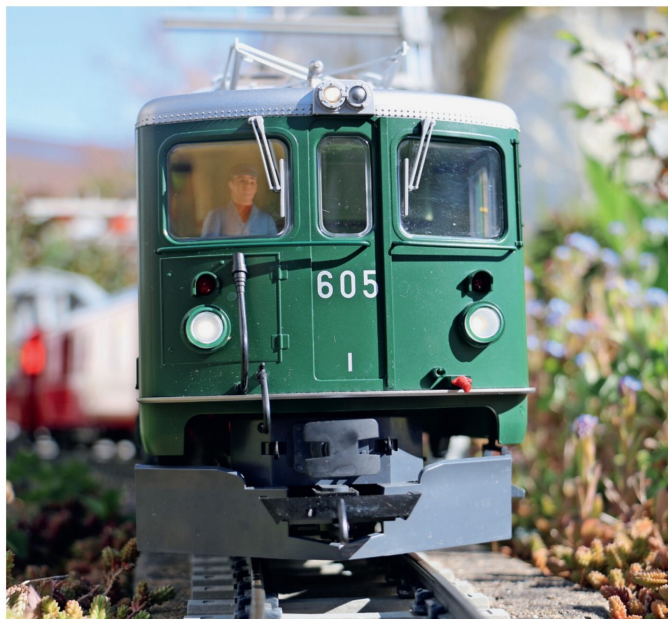
Ein Blick auf die Front mit der konstruktionsbedingt leicht nach links versetzten Lokpfeife.
