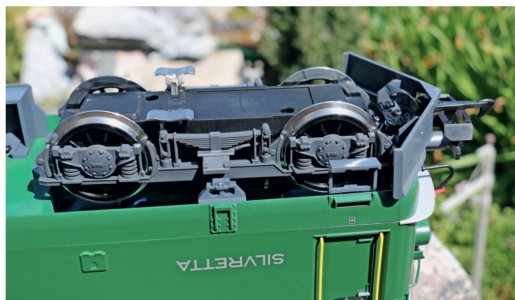
Der Motorblock der Lokomotive mit der bewährten LGB-Stromabnahme.
