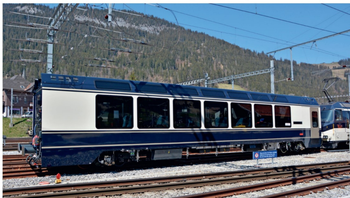
Seitenansicht des auf Meterspur stehenden Bsi 293. Man beachte links die Normalspurpuffer.
