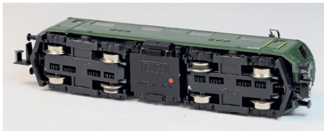
Die fertig digitalisierte Lok von unten betrachtet. Der rote Punkt sagt aus: Digitaltechnik an Bord.
