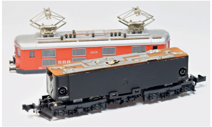
Leistungsgewicht bis unter das Dach, für die gewünschte Digitaltechnik scheint kein Platz zu sein.
