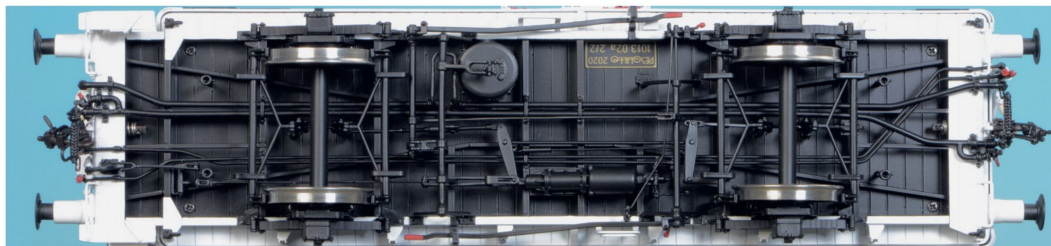
Grossartige Detaillierung auch am Unterboden: Deutlich zu sehen sind der grosse Vakuumbremszylinder und die seitlichen Handbremshebel.
