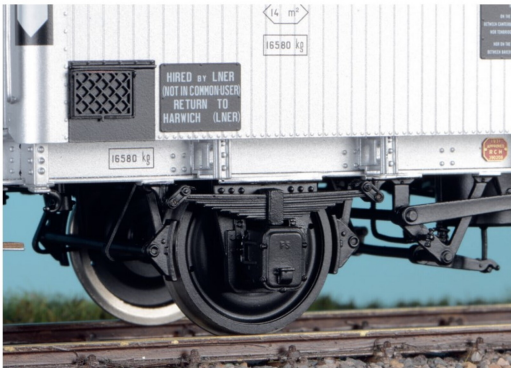
Vor allem die Kühlwagen der englischen Version waren mit den alten FS-Gleitlagern und der Einfachfederung versehen.
