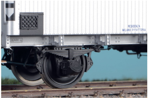
In den älteren Wagen mit dem italienischen Lichtraumprofil drehen die Achsen in den auffälligen «Schweineschnauzen-Lagern».
