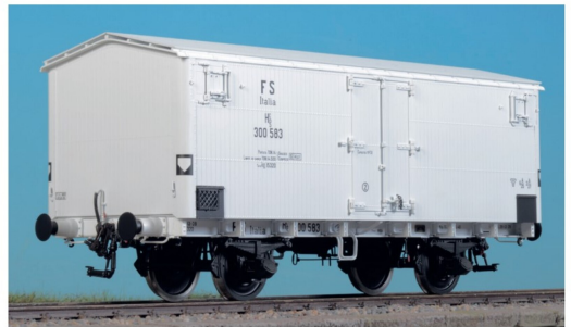
Die FS-Version von 1935 bis 1945 besass eine Dampfheizung.
