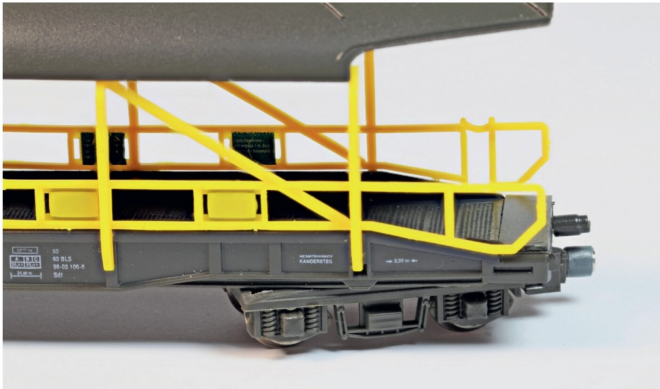
Das bearbeitete Drehgestell wieder eingebaut. Der befeilte Drehgestellrahmen fällt so kaum auf.
