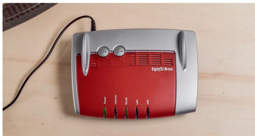
Es wird ein WLAN-Router benötigt. Auch hier muss nicht viel angeschlossen werden. Diese Fritz!Box braucht lediglich eine Stromversorgung.
