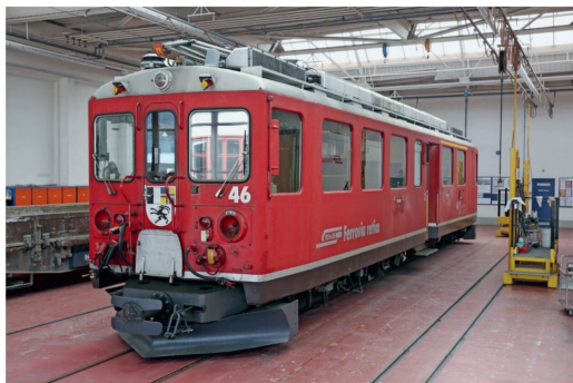
Der am 19. Februar 2021 von Pontresina nach Landquart überführte Triebwagen in der Vorbereitungshalle der Lackiererei. Hier wurden in einem ersten Schritt diverse Anbauteile demontiert.
