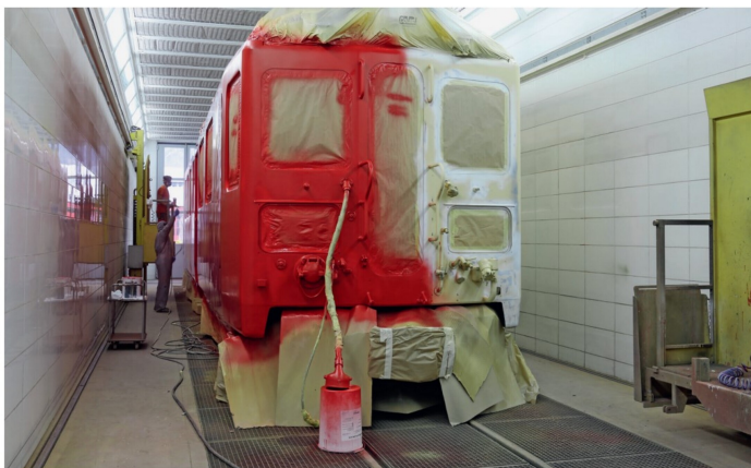
Den definitiven Anstrich erhielt der Triebwagen am 12. März 2021. Dazu wurde der Kasten am Morgen zuerst zweimal mit rotem Basislack und am Nachmittag zweimal mit Klarlack gespritzt.
