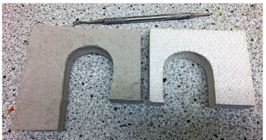
Die beiden Tunnelportale wurden aus Gips gegossen. Das Mauerwerk wird vor dem endgültigen Austrocknen mit einem Stichel eingeritzt.
