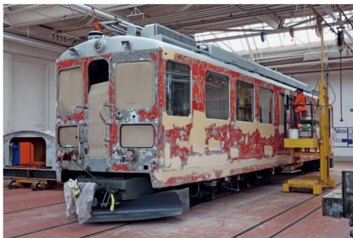
Im Anschluss an die Schleifarbeiten wurden kleinere Beulen oder durch Anschleifen entstandene Unebenheiten mit einer Spachtelmasse (beige) egalisiert und nochmals überschleift, hier am 9. März 2021.
