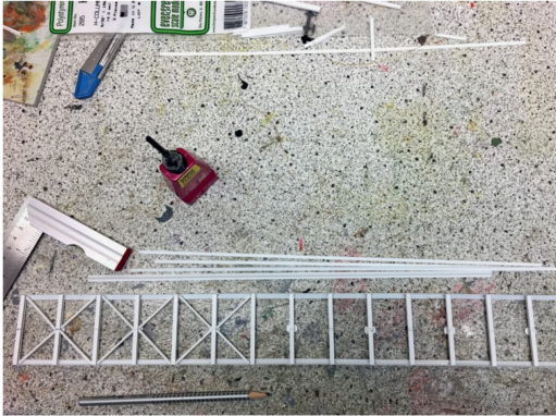
Die 14 Felder (Gefache) der Brücke bestehen aus Evergreen-Profilen. Sie werden genau im rechten Winkel ausgerichtet und verklebt.
