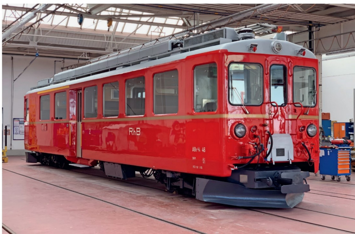
Den definitiven Anstrich erhielt der Triebwagen am 12. März 2021. Dazu wurde der Kasten am Morgen zuerst zweimal mit rotem Basislack und am Nachmittag zweimal mit Klarlack gespritzt.
