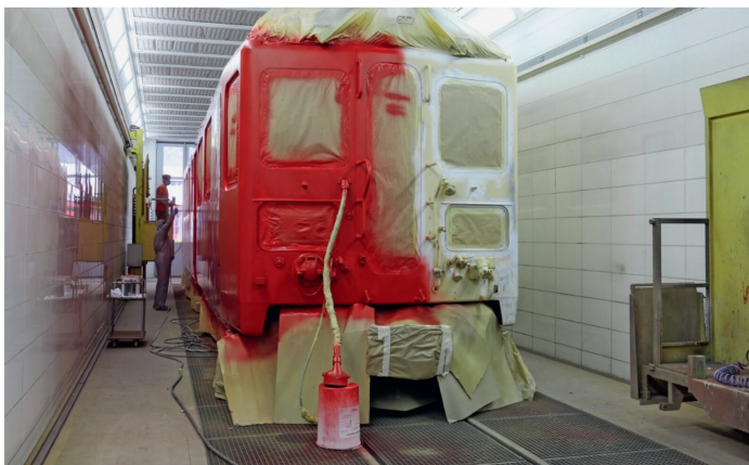
Den definitiven Anstrich erhielt der Triebwagen am 12. März 2021. Dazu wurde der Kasten am Morgen zuerst zweimal mit rotem Basislack und am Nachmittag zweimal mit Klarlack gespritzt.
