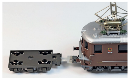
Lok und Auffahrwagen auf die zweipolige Magnetkupplung umgerüstet.
