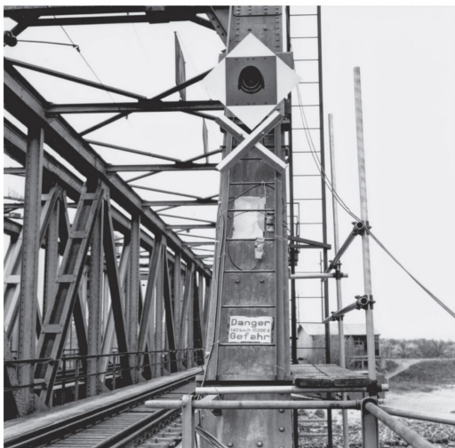
Aufwendig wurde die Rhonebrücke für die Messungen verkabelt.
