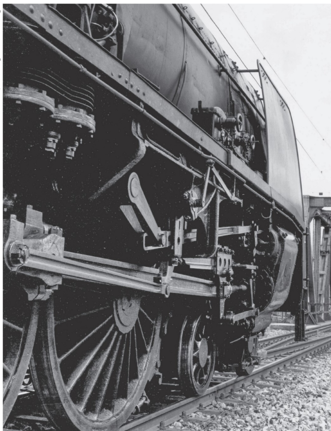
Stolze 1800 mm messen die Triebräder der drei Antriebsachsen der mächtigen Lokomotive.
