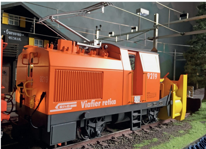
Der Aufbau wurde im kompletten Eigenbau aus ABS-Kunststoff erstellt.
