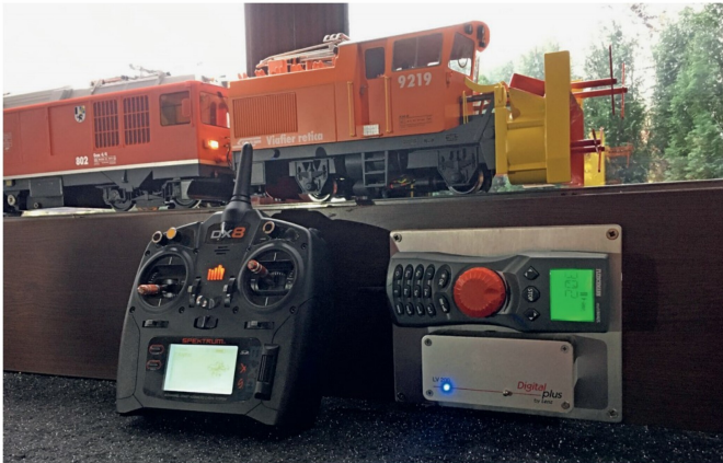
Gesteuert wird das orange Ungetüm mittels Fernbedienung und Fleischmann-Lok-Maus.
