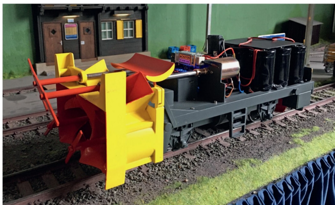
Das fertige Messingscheiderwerk vor der Veredelung mit dem ABS-Kunststoff-Gehäuse.
