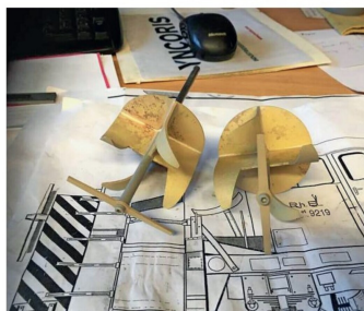
Die Messer an den Schleuderrädern lassen sich zum einfacheren Ersetzen abschrauben.
