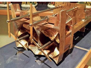
Komplett aus Messing gefertigt wurden das Fahrwerk und das Schleuderwerk.
