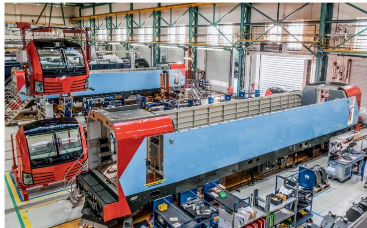
Setzen des Frontends bei der 193 461 der SBB Cl. Im Hintergrund wartet die Schwesterlok.
