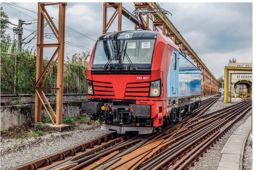
SBB CI Vectron 193 461 während der Inbetriebsetzung auf dem werkseigenen Testgleis mit vier Stromsystemen und Spurweiten.
