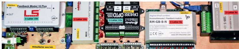
Die fünf für die Testanlage verwendeten Rückmeldemodule: Die Verkabelung ist noch nicht ganz abgeschlossen.
