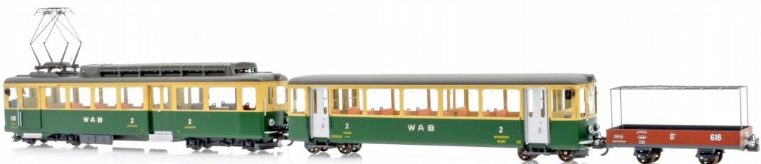
Der WAB-Pendelzug mit dem bekannten Vorstellwagen verkehrt im Modell auf 9-mm-Gleis (Spur H0e – Vorbild Spurweite 800 mm).
