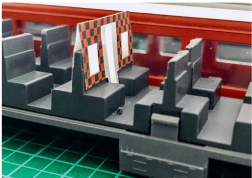
Die fehlende Zwischenwand wird mittels Papierausdruck nachgebildet.
