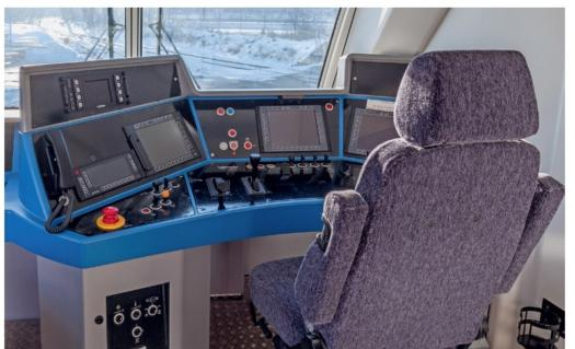
Blick in den Führerraum eines MS-Vectron mit hoher Führertischkonsole.
