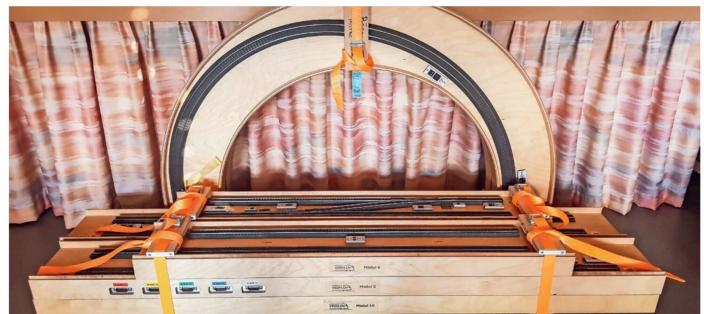
Transportbereit: Farbige Beschriftungen der D-Sub-Stecker sind Verbindungen zum Anschlussbrett.
