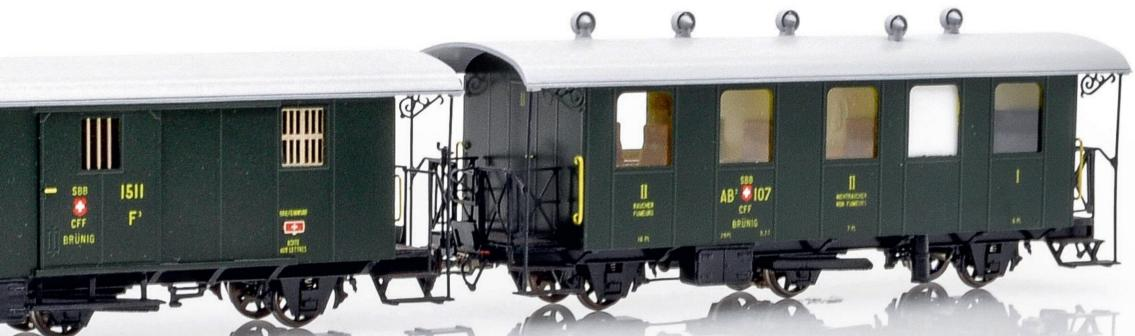
Mit den Modellen von H-R-F kann ein stilechter Brünig-Bahn-Dampfzug gebildet werden: Dampflokomotive HG 3/3 1068 mit Wagen F3 1511 und AB3 107.
