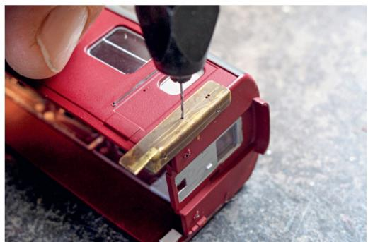
Bohren mit der Bohrlehre, neben der Tür wurde das Loch schon gebohrt.
