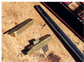
Die eigns angefertigten Bohrlehrn.
