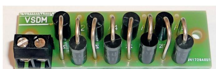
Anschlussprint Diodentrick für acht Rückmeldeabschnitte. Auf der Platine ist nur eine Diode.
