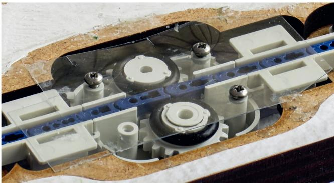
Um zu verhindern, dass die Kette aus dem Motorantrieb herauspringt, wenn gerade ein Langläufer vorbeifährt, montiere ich eine durchsichtige Acetatfolie.
