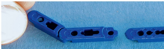
Bevor ich mit der Montage der Kette beginne, reinige und schleife ich die einzelnen Glieder. Die Kunststoffteile lassen sich jeweils sehr leicht zusammenfügen.
