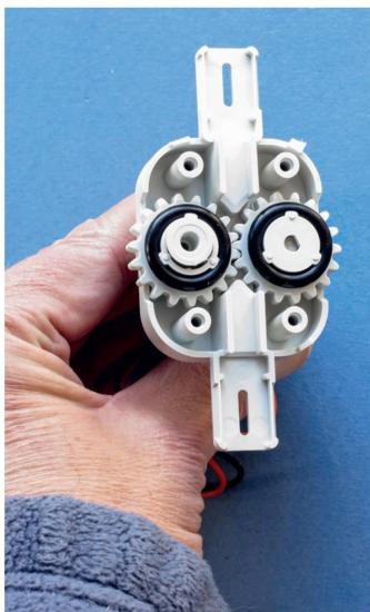
Die Oberseite des Motorgehäuses, das in die U-förmige Rinne eingeklipst werden kann.
