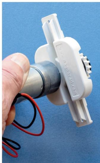
Der mitgelieferte 12-Volt-Motor wird mit zwei kleinen Schrauben am Motorgehäuse befestigt.
