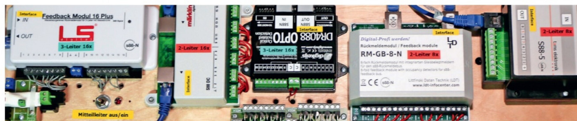
Die fünf für die Testanlage verwendeten Rückmeldemodule: Die Verkabelung ist noch nicht ganz abgeschlossen.
