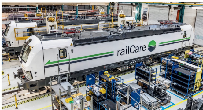
Gut zu erkennen: zusätzliche Lüftungsgitter (im mittleren Dach) für das Diesel-Power-Modul.
