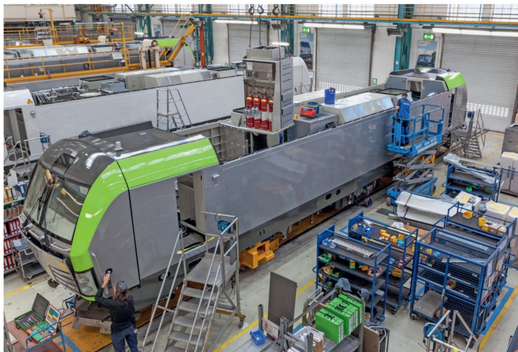
Gerüstmontage bei der Re 475 408 der BLSC. Das Hilfsbetriebegegerüst wird gerade eingehoben.
