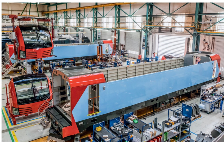
Setzen des Frontends bei der 193 461 der SBB CI. Im Hintergrund wartet die Schwesterlok.
