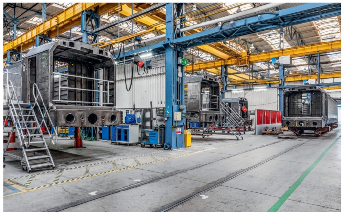
Blick in die Wagenkastenfertigung. Das Frontend wird erst in der Endmontage montiert.
