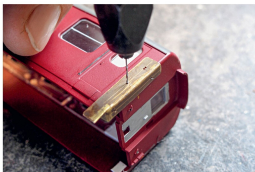
Bohren mit der Bohrlehre, neben der Türe wurde das Loch schon gebohrt.
