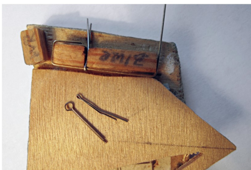
Herstellung von Griffstange und Trittstufe für die Stirnseite in einer Lehre.
