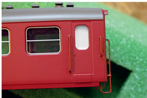
Lackierte und fertig eingebaute Griffstangen an der Küchentür des WR.
