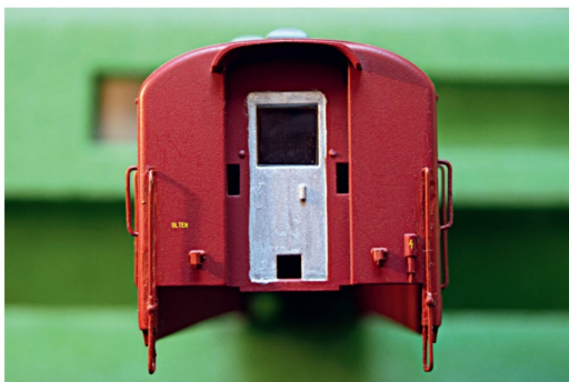
Hier sind die lackierten und fertig eingebauten Schluss Scheibenhalter.
