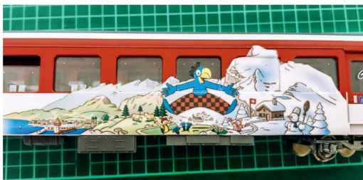
Entlang der Fensterränder wird die aufgesetzte Folie ausgeschnitten...
