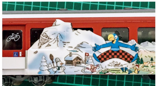
Die Folie wurde mittels Föhn erwärmt und in die Fensteröffnung gedrückt.
