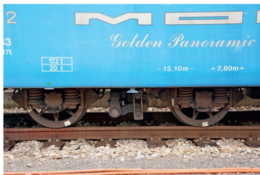
Der Blick auf die Drehgestelle zeigt, dass diese noch immer Speichenräder aufweisen. Auch wurden sie nicht wirklich umgebaut.
