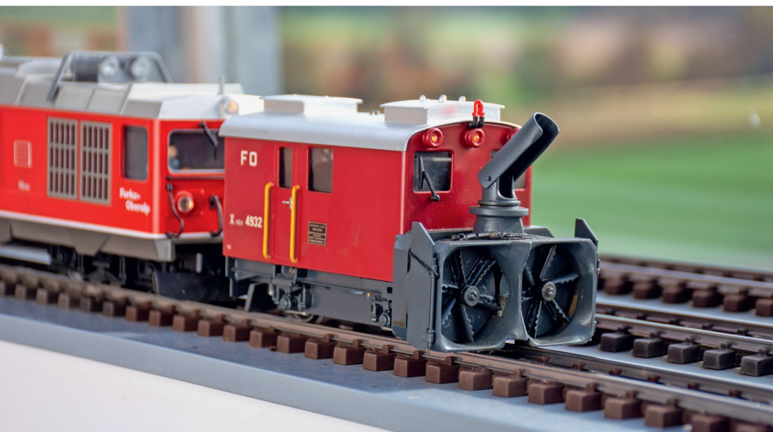
Der auf «Zwillingskufen» aufgebaute Mittelpflug wird bei den Weichen automatisch angehoben.
