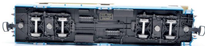
Beim Wagenunterboden wurden die Luftleitungen und -behälter der Bremsanlage nachgebildet.
