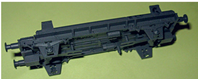
Bei genauem Hinschauen erkennt man den in U-Form ausgeführten Schnitt am Unterbau des Wagens.
